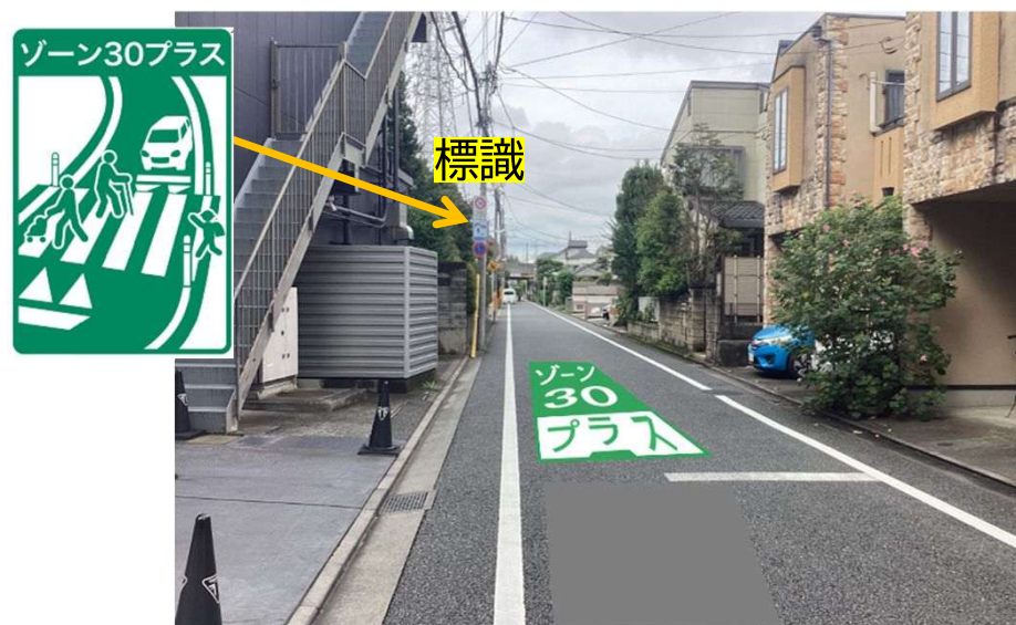
設置イメージ(路面標示+標識)
