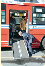
▲大型の路線バスも見学。ステップ下にスロープが収納してあります
