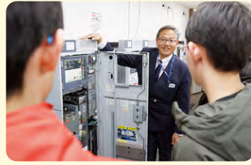
▲券売機の裏側。モニターのほか料金箱や切符の原紙が収納されています
