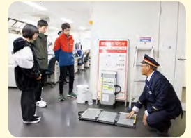
▲車両とホームの間に掛ける折り畳み式のスロープ
