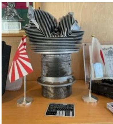
中島飛行機製 零戦のエンジン
