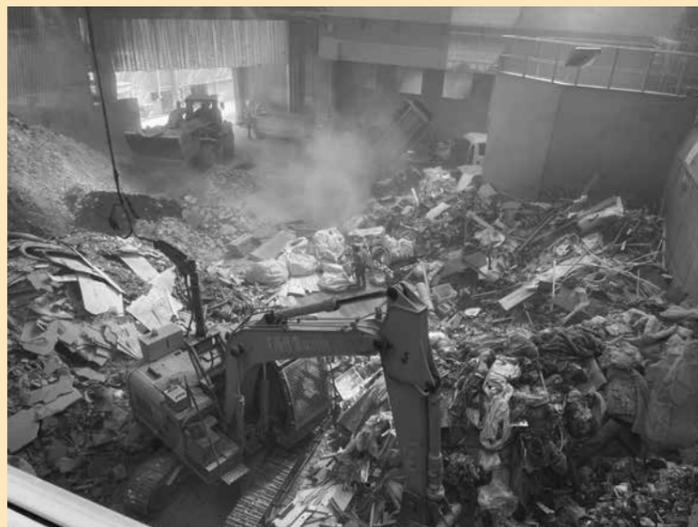
運ばれてきた住宅廃材を重機で解体、選別していきます。工場内で生じる粉塵は、1～10ミクロンまでの埃をキャッチする集塵機で処理されます。
