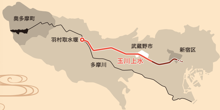
▲玉川上水の現況 — 開渠(ふたのない水路)部分 — 暗渠(地下水路)部分
