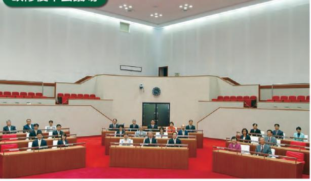
地震（東日本大震災）のために本会議場の一部が損壊しましたが、改修工事が終わり、今定例会から通常どおり使用することができました。天井を全面改修し、耐震性能を高めるとともに、照明器具は吊り型から埋め込み型へ改修しました。また、メンテナンスや省エネルギーに考慮し、LEDを使用しています。
