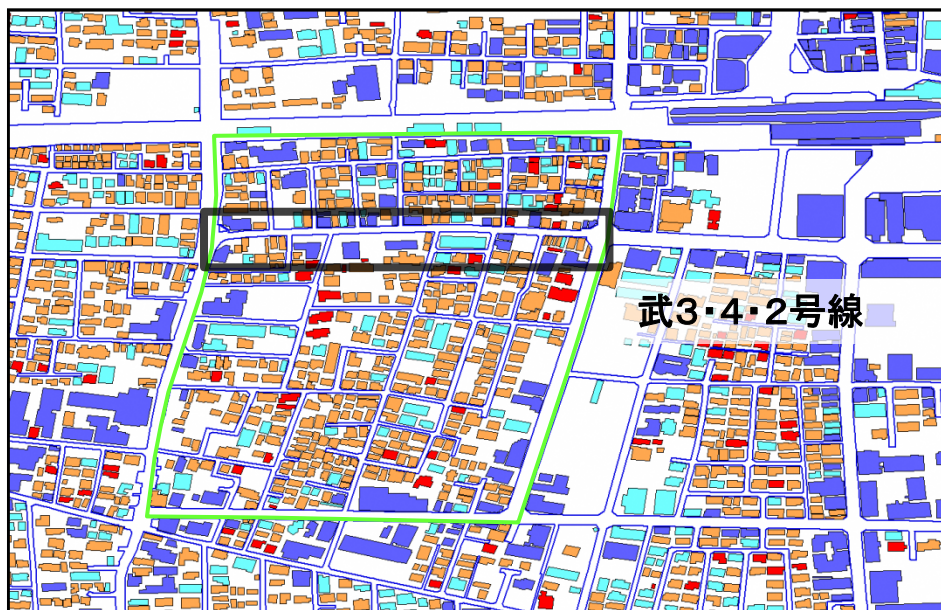
① 3・4・2号線拡幅前(幅員7.4m)
