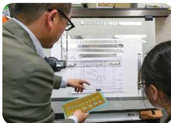
▶ ドラフター（製図台）を使うと、簡単に線が引けます。
