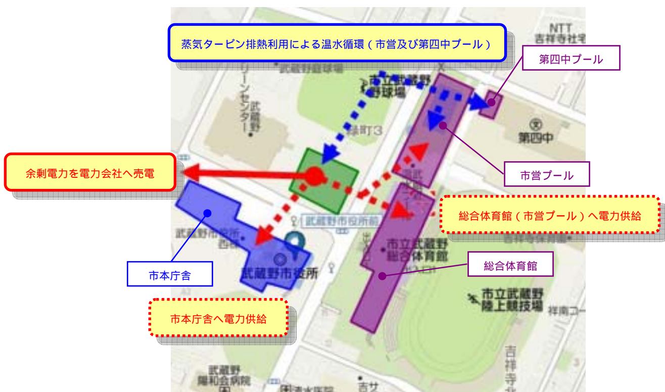
図 新クリーンセンター余剰電力及びエネルギー利用案(近隣公共施設を含む)
