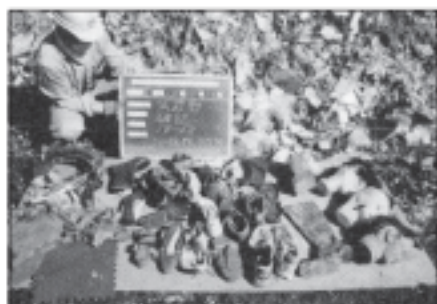
処分場で指摘を受けた15センチメートル以上の違反物。スニーカーなどゴム製の靴類が目立ちます。
