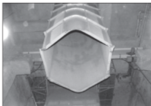
爆発事故で大破して大きく歪んだ設備。
