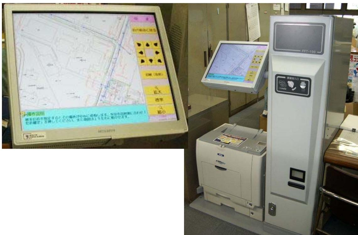
図-18 下水道台帳自動閲覧機
