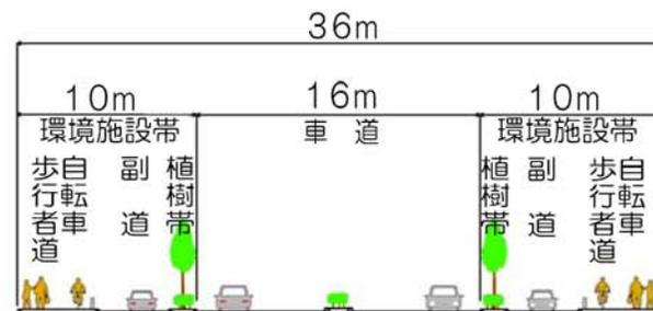
※車道の両側 10mの部分「環境施設帯」です。幹線道路の沿道の生活環境を保全するために設置されるもので、植樹帯・自転車歩行者道・副道などの組合せで構成されます。
