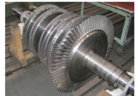
蒸気タービンの中に入っている動翼です。タービンの内部は、歯車のようになっていて、回転することで発電します。
