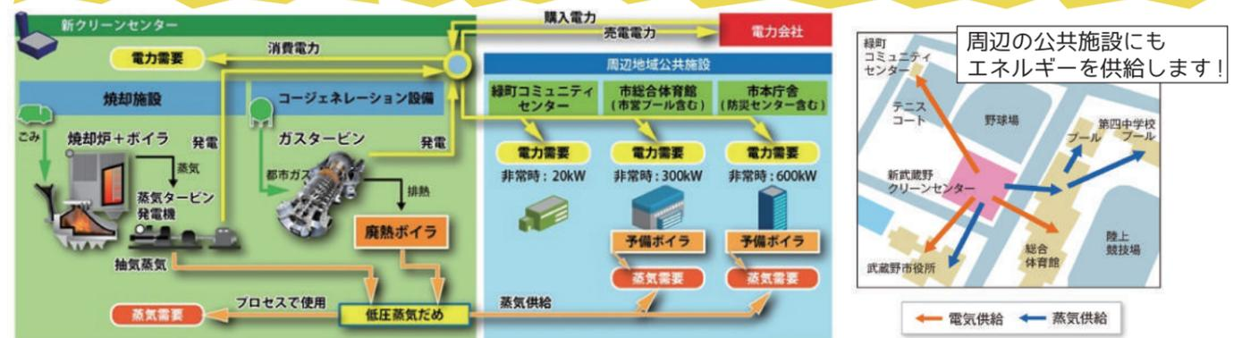
焼却炉により、可燃ごみは850℃～1000℃で燃やします。その際に発生する熱を利用して、高温・高圧ボイラにより蒸気を発生させます。この高温・高圧の蒸気を使って、蒸気タービン発電機を動かし、発電を行います。また、新クリーンセンターには清掃工場では全国初の試みとして、常用ガス・コージェネレーション設備も併設します。このことにより、災害などによる停電時においても、災害に強い中圧ガス管からガス供給を受け、ガス・コージェネレーション設備を稼働、発電し、焼却炉を運転させるとともに、市役所、総合体育館、緑町コミュニティセンターへ電力を供給します。平常時においても夏の電力不足の際に対応します。
