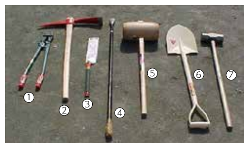
①ボルトクリップ（60cm） ②つるはし ③片刃のこぎり（26.5cm） ④てこバール（120cm） ⑤かけや ⑥剣スコップ ⑦両口ハンマー（4.5kg）
