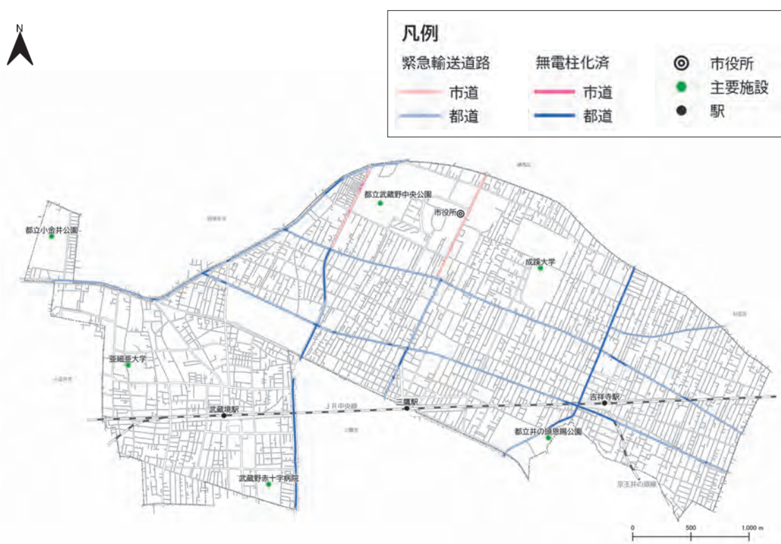
図3-8 緊急輸送道路の無電柱化状況図
