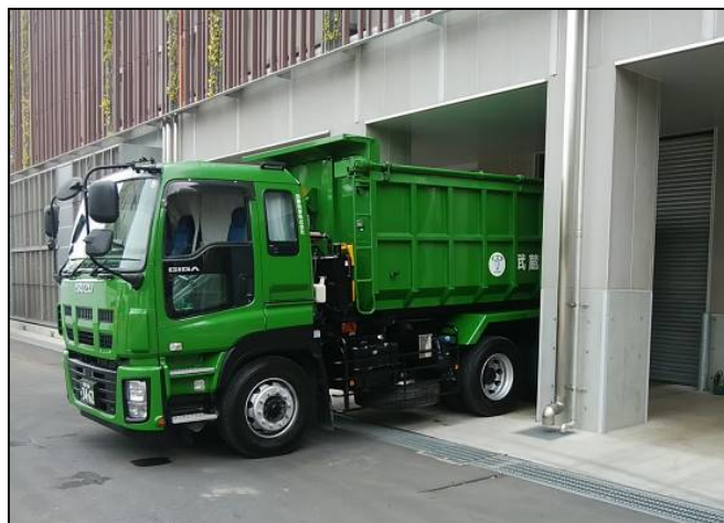
てんがいつき 天蓋付灰運搬車（主灰）
