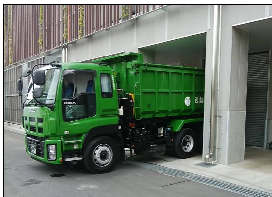
てんがいつき 天蓋付灰運搬車（主灰）
