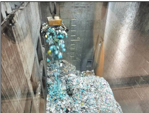
収集車がごみをおろす様子（上）、可燃ごみピットの様子（下）
