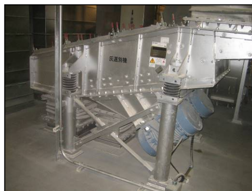
灰選別装置の一部（粒度選別機）
