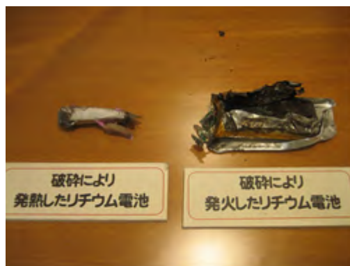
破砕により発火したリチウムイオン電池
