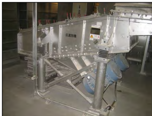
灰選別装置の一部（粒度選別機）
