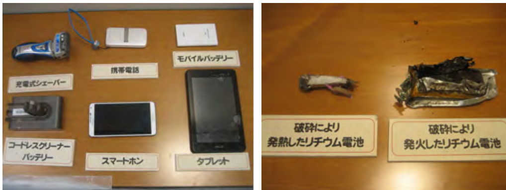
リチウムイオン電池内蔵の小型家電 破碎により発火したりチウムイオン電池
