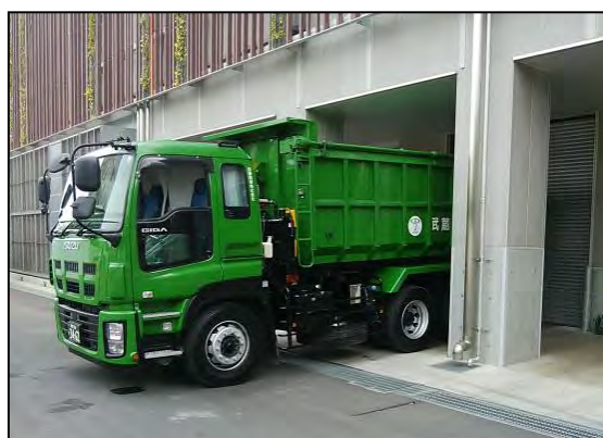
てんがいつき 天蓋付灰運搬車（主灰）
