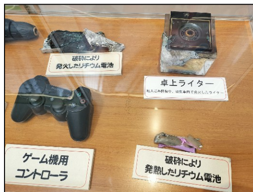
破碎により発火したリチウムイオン電池
