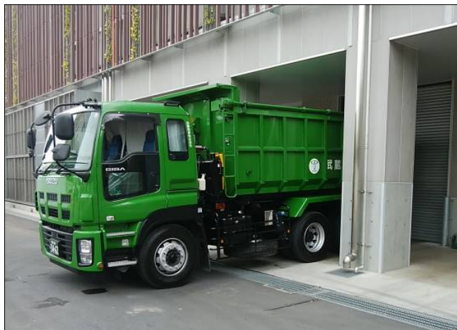
てんがいつき 天蓋付灰運搬車（主灰）
