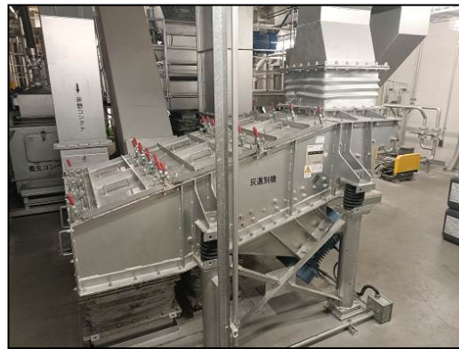
灰選別装置の一部（粒度選別機）
