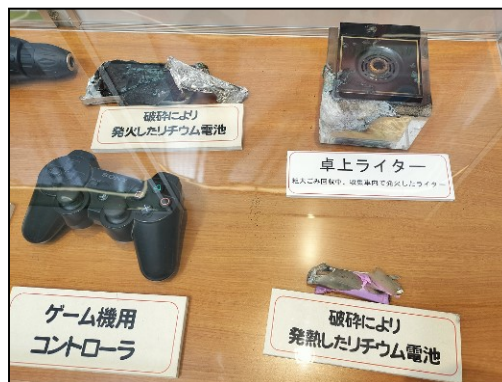
破碎により発火したリチウムイオン電池
