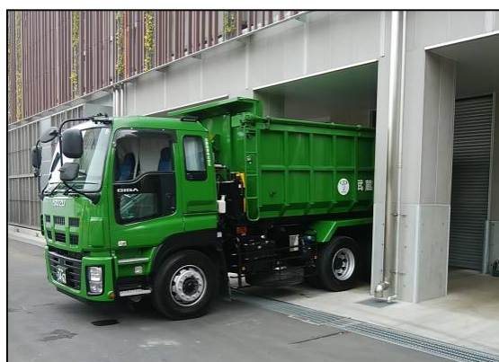
てんがいつき 天蓋付灰運搬車（主灰）
