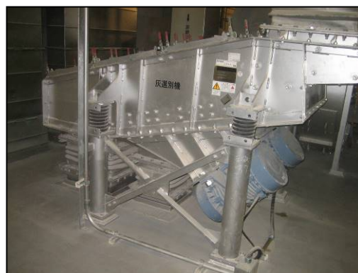
灰選別装置の一部（粒度選別機）
