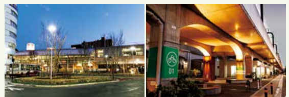
(左) 北口駅前広場はどこを歩いても10ルクスの明るさが取れるよう設計されている。(右) 高架の底部が光をよく反射し、間接照明のように周囲を照らす。
