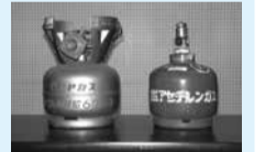
LPガス、アセチレンガスボンベ
