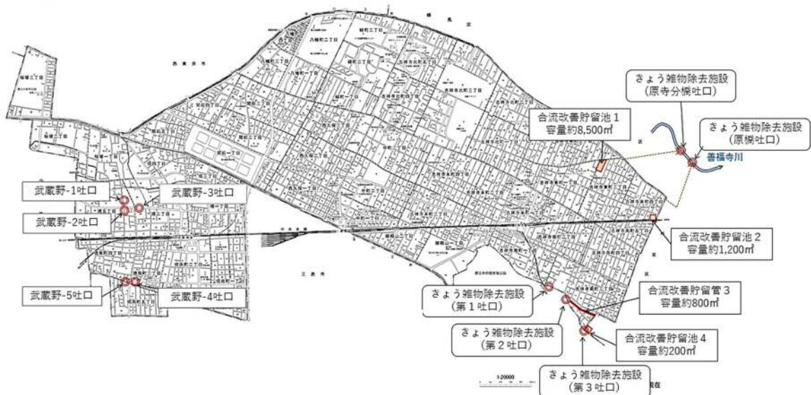
図 21 合流式下水道改善対策施設配置図(合流改善施設・きょう雑物除去施設)
