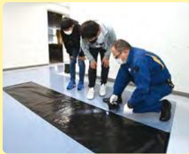
▲地面の上に敷いたビニールシートに静電気を当てて足跡を写し取る
