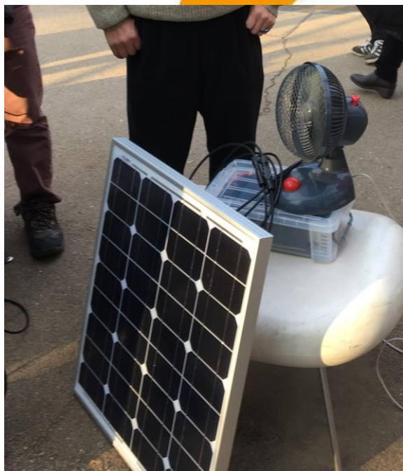
2017年セミナー後、屋外で扇風機(キットに含まれません)を回して発電動作確認したときのようす。
