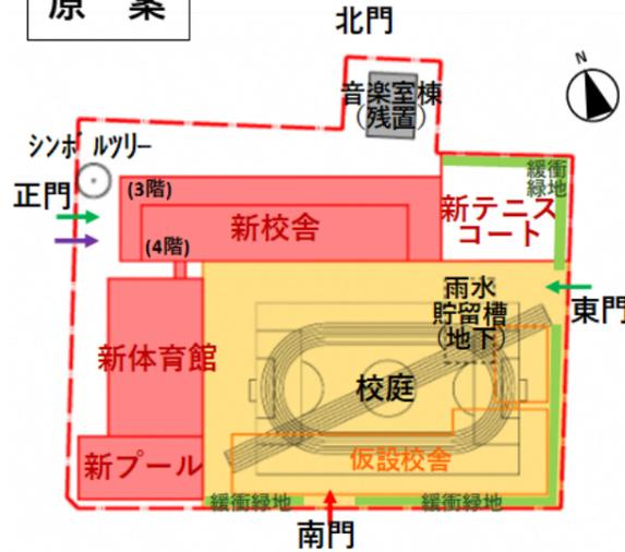
仮設校舎を建設し、引越し後に既存校舎・体育館を解体、跡地に新校舎・新体育館を建設するプラン。既存の配置に最も近いプランであるが、日影規制により、建物北側が階段状になる。生徒の動線は、既存の正門からのアプローチとなる。工事期間中は体育館が使用できなくなるため、近隣の施設を利用する必要がある。
