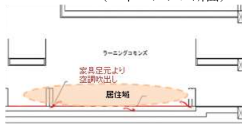
アンダーフロア空調とすることで、天井高を確保します
