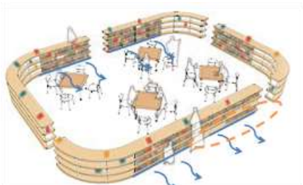
家具の足元から温風・冷風を吹く空調
