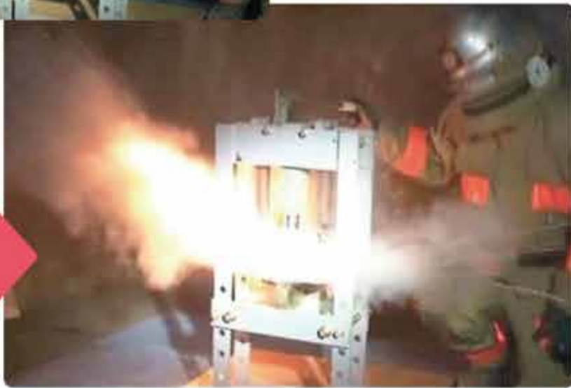
リチウムイオン電池(充電電池)の圧潰実験 東京消防庁
