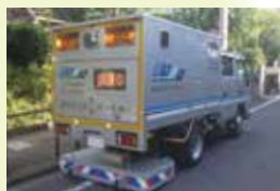
舗装下の空洞調査の様子
