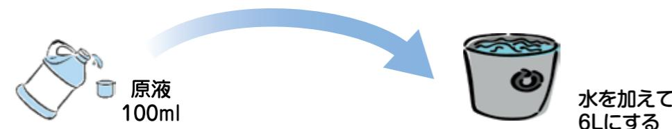
次亜塩素酸ナトリウムは塩素系漂白剤の成分です。一般的な市販品の原液濃度は5~6%ですが、製品の表示で濃度を確認してください。また消毒する際に塩素ガスが発生することがあるので、使用時は十分に換気してください。
