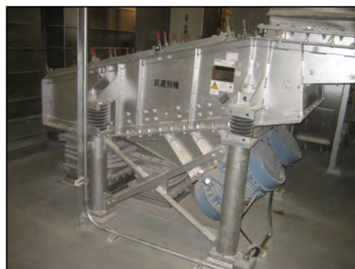
灰選別装置の一部（粒度選別機）
