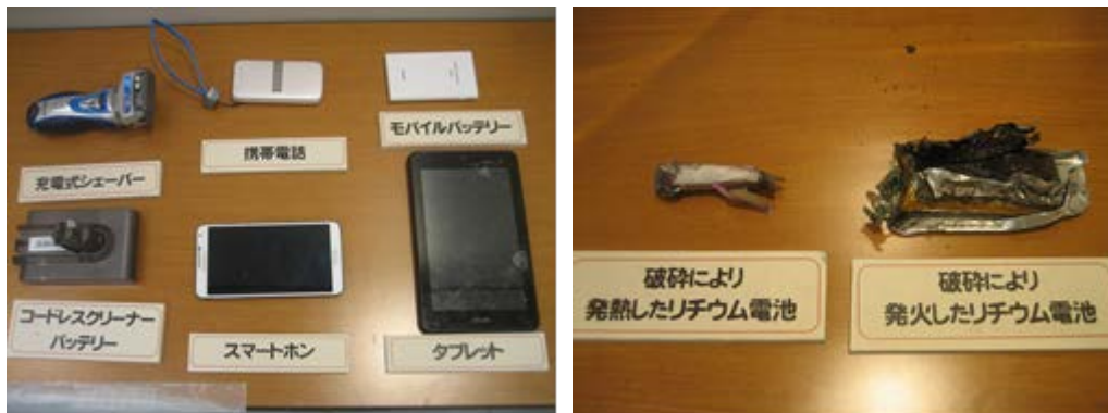
リチウムイオン電池内蔵の小型家電 破碎により発火したリチウムイオン電池
