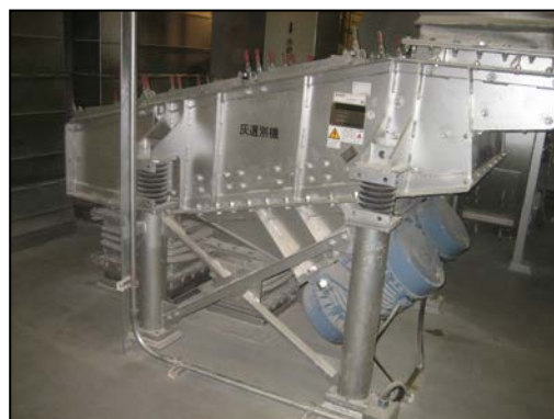
灰選別装置の一部（粒度選別機）
