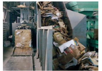
ベルトコンベアに乗せ圧縮プレス化する。
