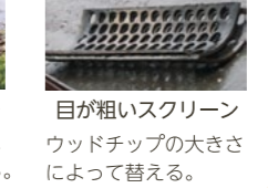
目が粗いスクリーン ウッドチップの大きさによって替える。
